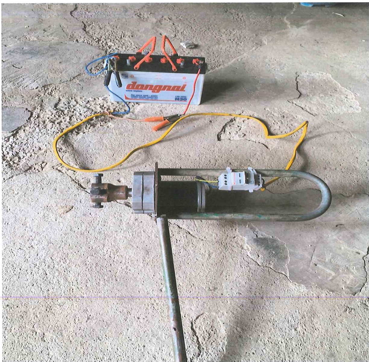
(Thiết bị đóng mở cổng bằng mô tơ tự chế sử dụng nguồn điện 1 chiều 12V đến 24V)
